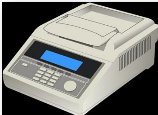
Figura 3.12. El termociclador es un instrumento indispensable para la agilizar de la técnica RCP.
